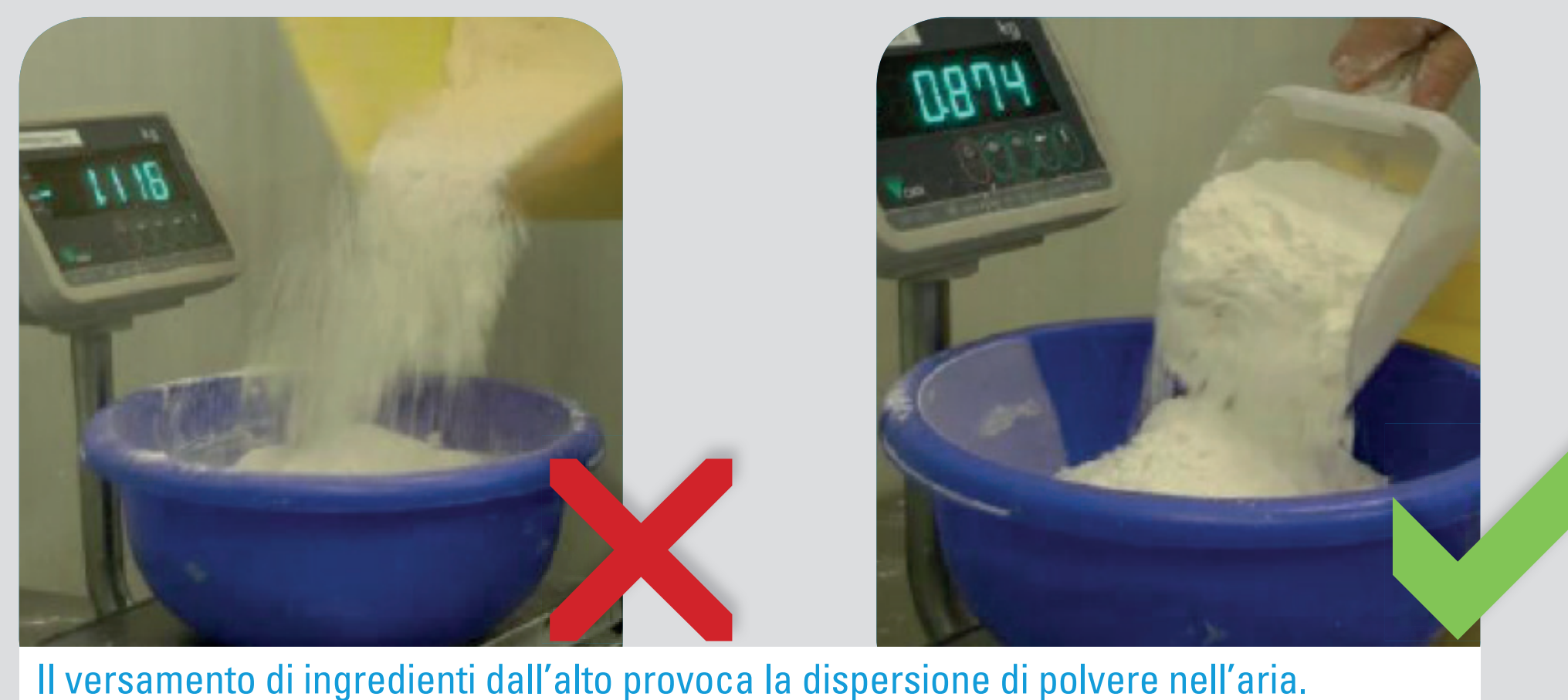
Il versamento di ingredienti dall'alto provoca la dispersione di polvere nell'aria.
