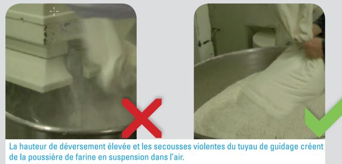
La hauteur de déversement élevée et les secousses violentes du tuyau de guidage créent de la poussière de farine en suspension dans l'air.
