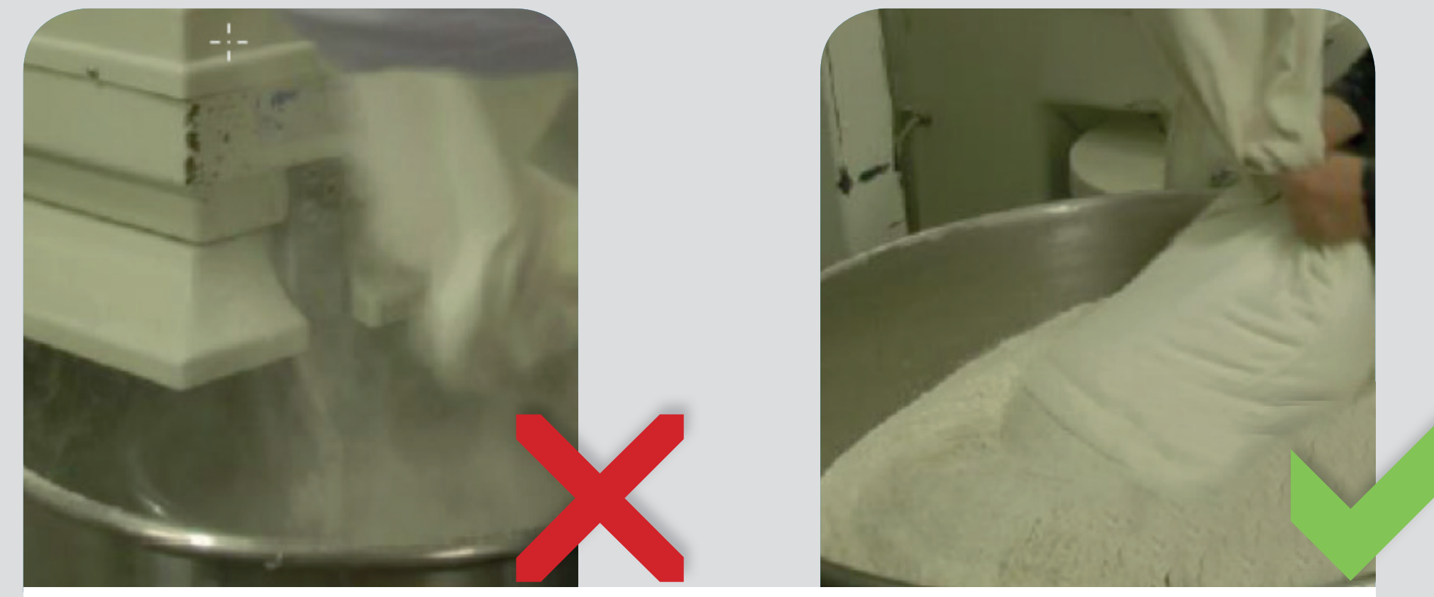
Te hoge storthoogte en te hevig schudden van de begeleidingsslurf veroorzaakt meelstof in de lucht.
