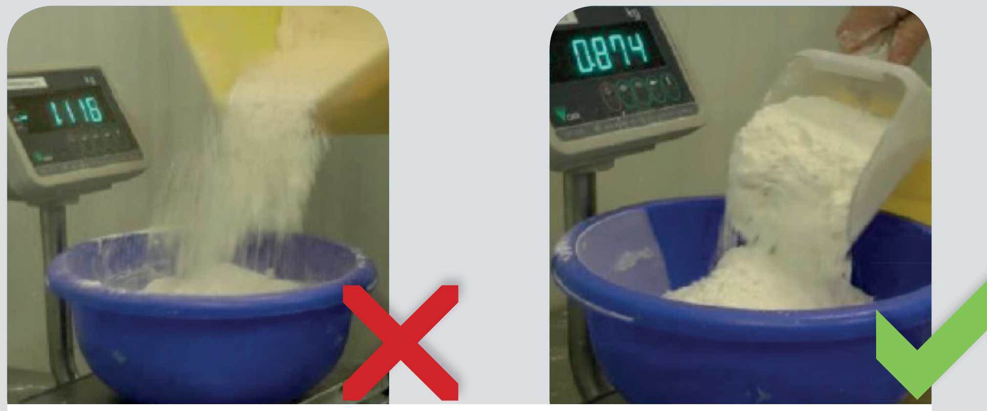
Het uitgieten van ingrediënten vanop hoogte veroorzaakt stof in de lucht.
